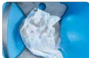
Le stamp est isolé du composite à l'aide d'un ruban de téflon. La polymérisation peut avoir lieu à travers la bande.
