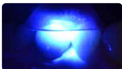
El estado gomoso se alcanza después de solo 3 s de polimerización
