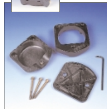
Nová kyveta s kapacitou o 10% větší a nové šrouby odolné mikrovlnnému záření
